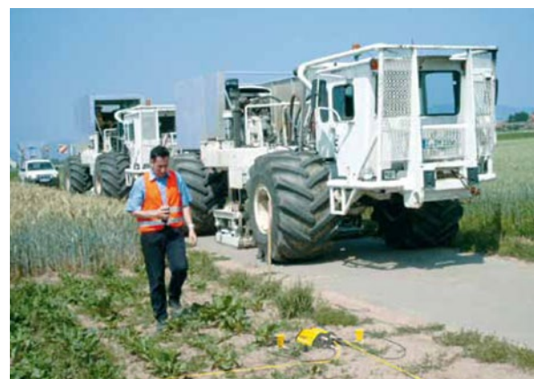
Vibrationsfahrzeug im Einsatz
