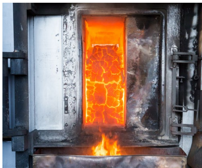
Halbtechnischer Versuchskoksofen von DMT
